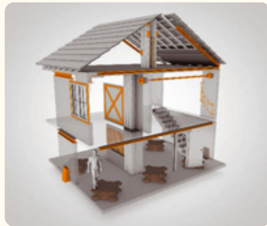
Figura 1 | Casa com vários elementos de construção (a cor de laranja) que a protegem dos efeitos de um sismo.
