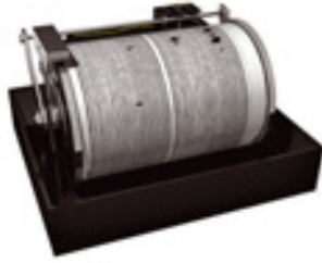
Figura 2 – Aparelho que regista as vibrações do solo.
